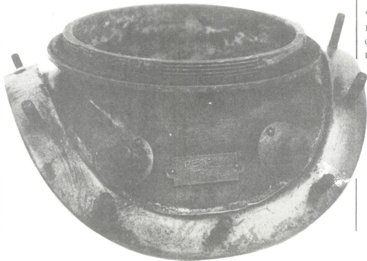
O capacete (acima) e o colarinho de um escafandro da Light: segurança na manutenção de usinas desde o começo do século
