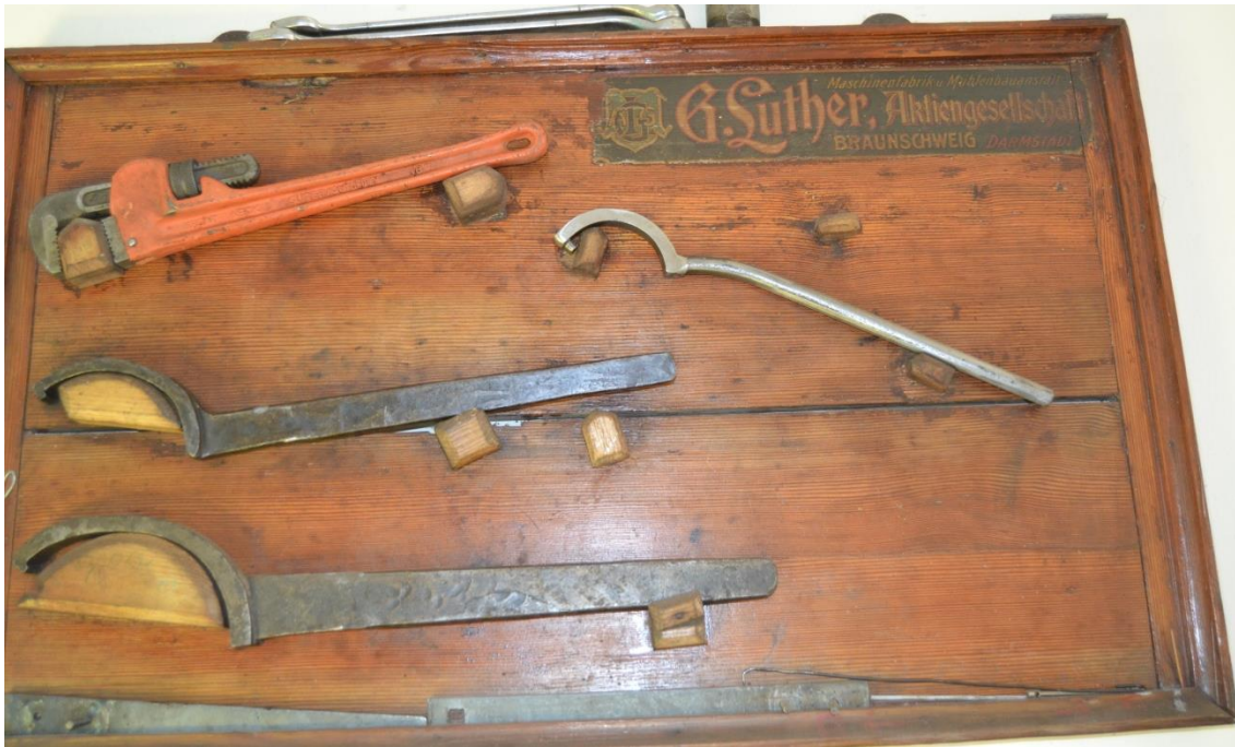
Santa Alice. Quadro de ferramentas de turbinas (G. Luther, Braunschweig, 1907). Foto: G. Magalhães 5/2/2014
