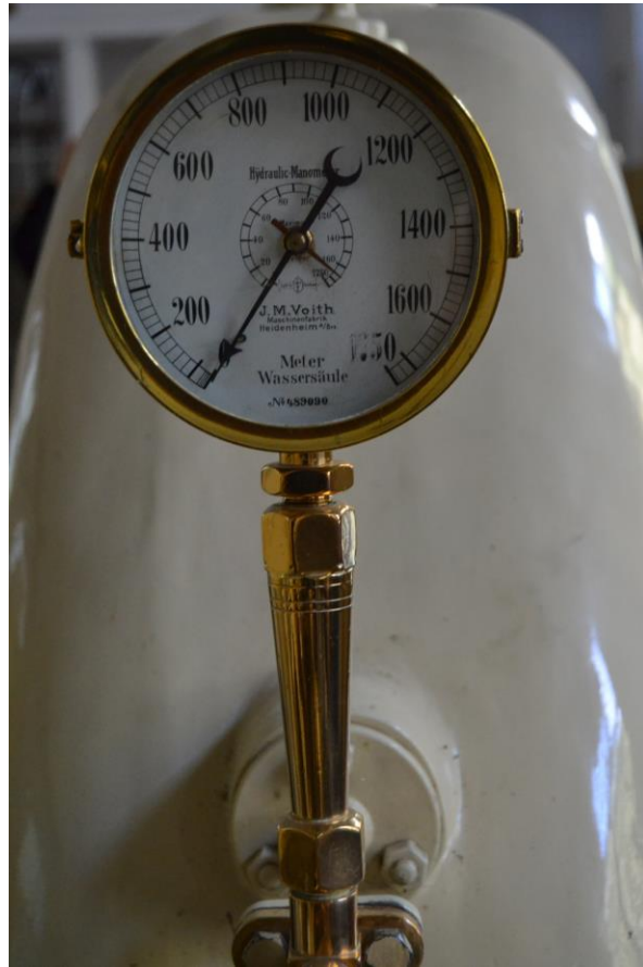
Isabel. Brilhante medidor Voith (Alemanha) de pressão de turbina. Foto: G. Magalhães, 24/7/14
