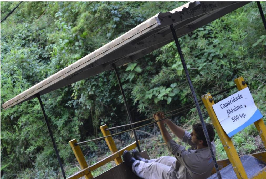
*Três Saltos.* Trólei para acesso à casa de força a partir da câmara de carga. Foto GM 8/1/2015
