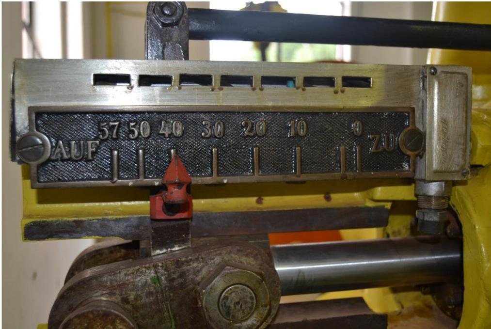
*Chibarro.* Detalhe da abertura da turbina no regulador original de velocidade da turbina, desativado.
