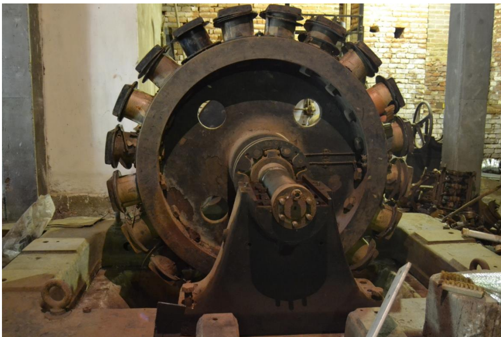
Itaiquara. Rotor do antigo gerador (Siemens-Schuckert). Foto Gildo Magalhães 26/2/15
