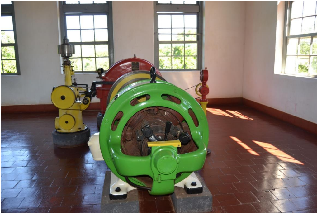
S. Joaquim. Museu: antigo conjunto - regulador de velocidade, turbina e gerador. O acoplamento entre gerador e turbina é feito por cordas. Foto GM 24/2/15
